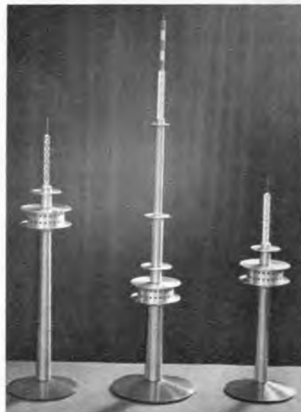
Fernmeldetypentürme der Deutschen Bundespost im Modell. Links: Typ FMT 2 für ungünstige topografische Lagen, Gesamthöhe 124 m, unterste Plattform in 75 m Höhe. Mitte: Typ FMT 3, speziell für Fernsehsender, Gesamthöhe 173 m. Rechts: Typ FMT 1 mit 99 m Höhe, die untere Plattform liegt bei 50 m
