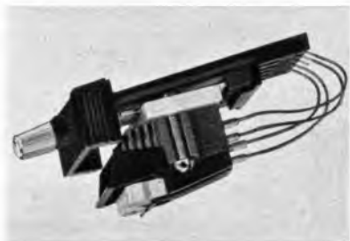
Bild 7. Die Schubladenkonstruktion des Tonabnehmerkopfes
