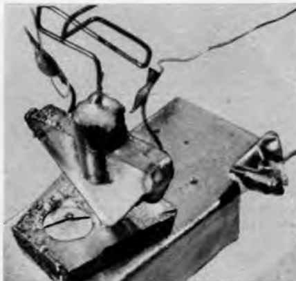
Bild 1. Das war der erste funktionsfähige Transistor der Welt vom Dezember 1947
