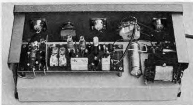
Links: Bild 6. Anordnung des Bausteins der Stromversorgung auf dem Chassis
