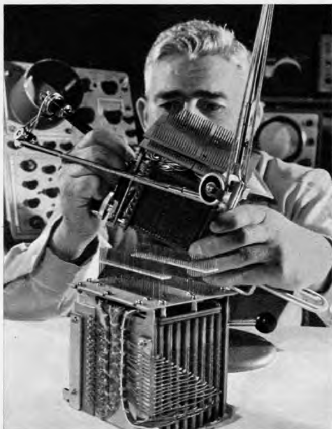
Bild 2. Hochgeschwindigkeitsspeicher für Mehrzweck-Computer besonders kleiner Abmessung. Die Datenverarbeitungsanlage wiegt nur 60 kg und hat doch die Leistungsfähigkeit einer um das Vielfache größeren Einrichtung in Normalausführung. Dieser „variable instruction computer“ wurde von der RCA als Regierungsauftrag für Raumfahrzeuge und Flugzeuge entwickelt
