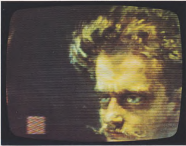
Bild 3. Leichte Gleichkanalstörung mit zusätzlicher Farbmoiré-Störung durch das 4,5-MHz-Rasterfeld des ARD-Testbildes, dessen Frequenz in das Seitenband des Farbträgers fällt. Dabei ergeben sich keine S-förmigen Linien, da der Störträger unmoduliert ist
