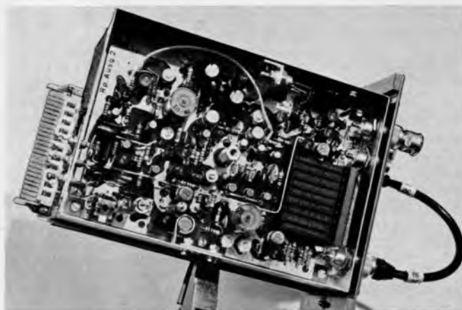
Bild 2. Bild-Zwischenfrequenzverstärker mit Amplitudenentzerrung. Der Kassettendeckel ist entfernt
