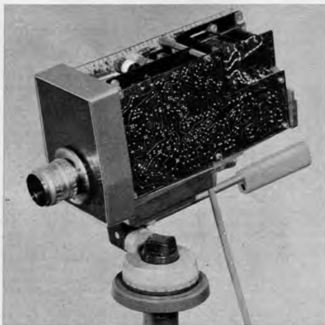
Blick ins Innere der Mini-Kompakt-Kamera von Philips bei abgenommenem Gehäuse.
