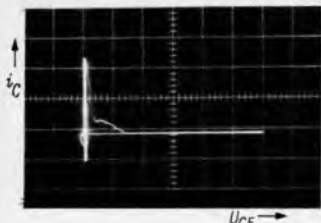
Bild 3. Schaltverhalten im Kennlinienfeld des Transistors T 1. i_{ss} \approx 10 \text{ A} ; u_{as} \approx 250 \text{ V}
