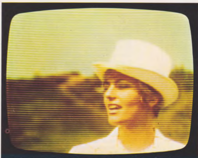
Bild 1. Durchlaufende horizontale Streifen bei schwacher Gleichkanalstörung. Das Farbprogramm vom Sender Hornisgrinde wurde durch das ARD-Schwarzweiß-Testbild des Senders Waldenburg gestört
