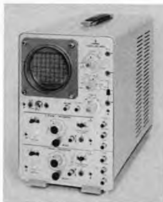
Der Zweistrahl-Oszillograf, Typ Oscillar M 911, von Siemens eignet sich für den Frequenzbereich von 0 bis 15 MHz. Für das Gerät stehen drei verschiedene Y-Verstärker-Einschübe zur Verfügung
